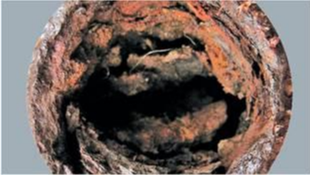
Мал. 48.2. Результати діяльності залізобактерій у водопровідних трубах
